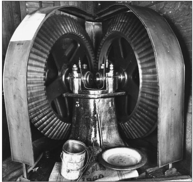
Das Winkelgetriebe überträgt die Kraft von der «neuen» Mühle (Putzerei) zur alten. (Foto KDP)
