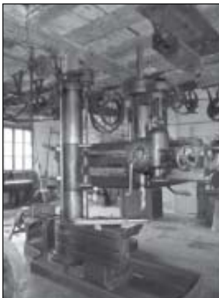
Bohrmaschine und Deckentransmission. HPB 2013
