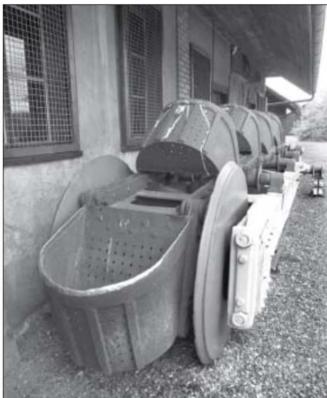
Kübelkettenaufzug eines dampfbetriebenen Eimerketten-Schwimmbaggers, der ab Ende 1920er Jahre bei der Bätzimatt verankert war. HPB 2013
