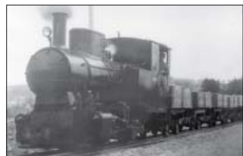
KIBAG-Kieszug auf 750mm-Gleisen mit Hanomag-Lok von 1920, ab 1935 in Nuolen in Betrieb, 1942 in der Werkstatt Bätzimatt renoviert für den Einsatz auf der Kraftwerkbaustelle Rapperswil-Wildegg. KIBAG um 1940
