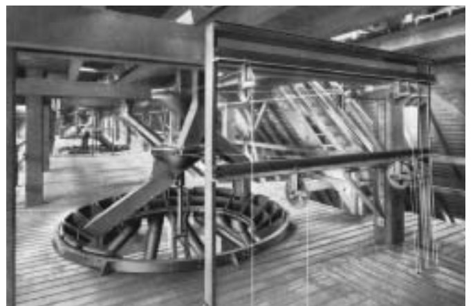
Doppelte Drehrohrverteiler unter den Transportbändern im Dachraum. Anlagenbau der Fa. Gebr. Bühler, Uzwil
