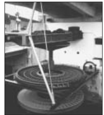
Alt und Neu vereint im Kraftwerk Mühlenplatz, Luzern: als Denkmal am alten Standort neu montierte Joval-Turbine von 1889, eingeweiht im Rahmen der «150 Jahre Bundesstaat-Aktivitäten» 1998.
