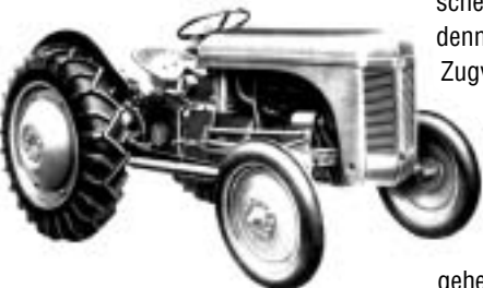
Ferguson-Traktor TE 20 mit 26 PS-Vierzylinder-Benzinmotor, Geräteanbau an serienmässiger Dreipunkt-Regelhydraulik (Baujahr 1948).
